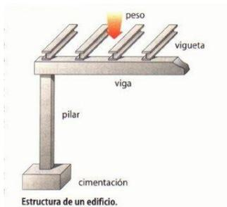
En este tipo de estructuras es muy importante la construcción de pilares (elementos verticales) y vigas (elementos horizontales). **Los pilares** suelen hacerse de hormigón armado y se construyen en el mismo sitio donde se hace la estructura
